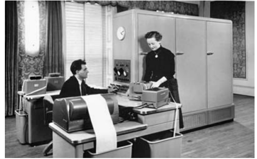
Figura 6 Imagen del ordenador Ferranti Pegasus-1, empleado por Arup en el proyecto de la Ópera de Sídney. Como se observa en la imagen, tenía el tamaño de un armario (Watson 2006)
