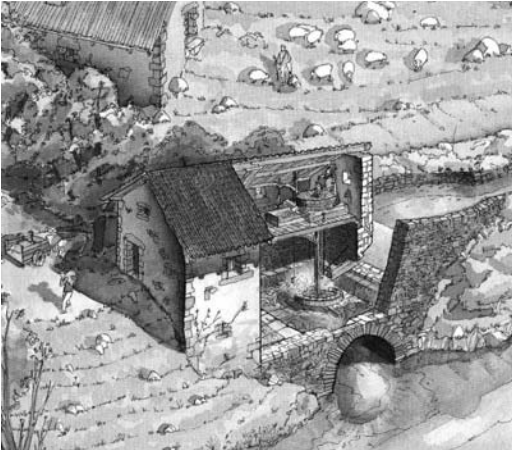
Figura 1 Dibujo esquemático sobre un molino hidráulico medieval de rodezno (Díaz 1998)
